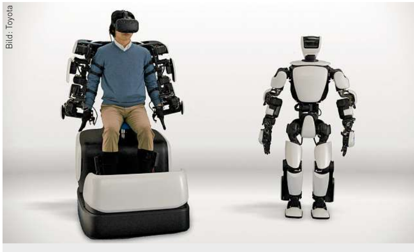
Bild: Toyota Der Roboter T-HR3 von Toyota soll die physische Interaktion zwischen Robotern und ihrer Umgebung besser gestalten. Mithilfe des Master Maneuvering System lassen sich menschliche Bewegungen mit dem Roboter darstellen.
